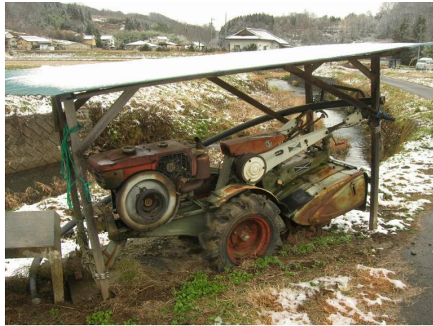
長年の稼働で外装からエンジン回りまで錆の発生
