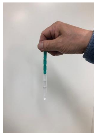
② 拭き取った綿棒を試薬キットに挿入し、ふき取り部と試薬を反応させる。
