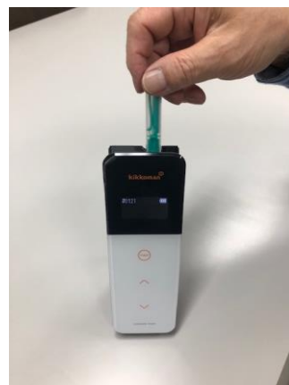
③ 反応させたキットをATP測定器に挿入しATP量を測定する。
